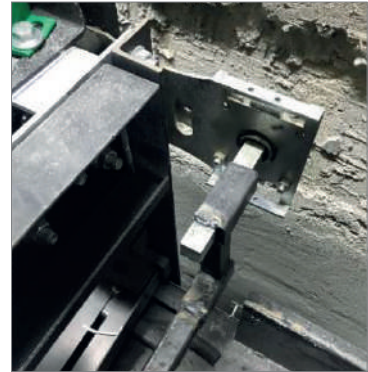
Resim-24 Güvenlik tertibatı aktarma kolunun montaj uygunsuzluğu
