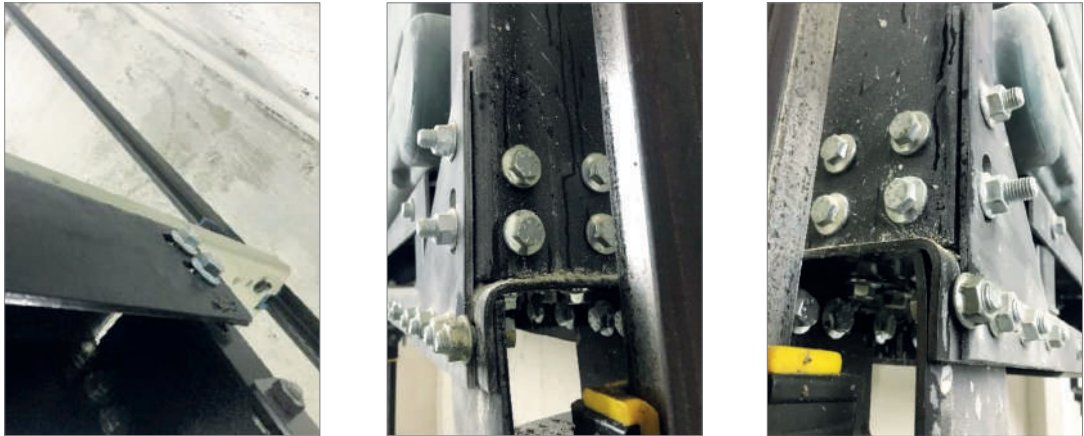
Resim-10 Karşı ağırlık karkas imalat hatası
