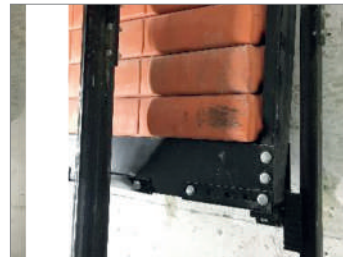
Resim-8 Yetersiz dayanıma sahip karşı ağırlık karkası tampon çarpması sonrası görünüm
